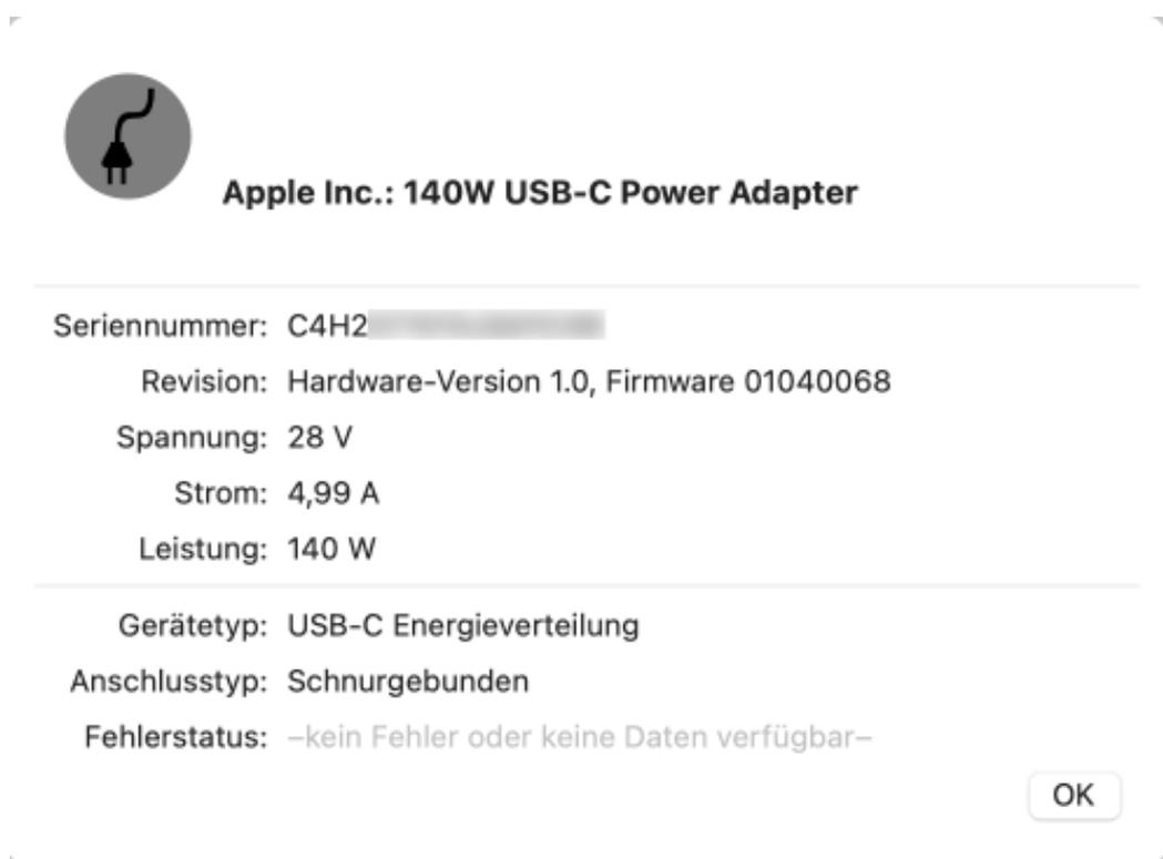
Abbildung 1.3: Beispielbericht über ein Apple-Netzteil. Bei Netzteilen mit USB-C-Technik zeigt der Bericht außerdem die aktuelle Ladebetriebsart, die von den Geräten ausgehandelt wurde.
